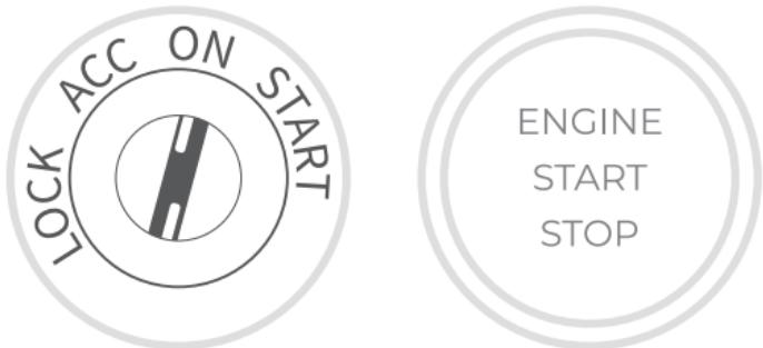
Mueva el interruptor de encendido a la posición "ON" o presione el botón "INICIAR/DETENER MOTOR" (si está equipado) hasta que el vehículo esté en modo "ON". No aplique los frenos cuando se presiona el botón "INICIAR/DETENER MOTOR".
