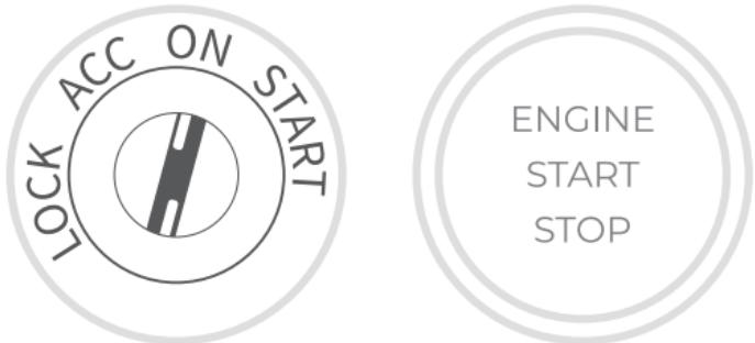
Mettez le commutateur d'allumage sur la position "MARCHE" ou appuyez sur le bouton "Démarrage Arrêt Moteur" (si équipé) jusqu'à ce que le véhicule soit en mode "MARCHE". Ne pas actionner les freins lorsque le bouton "Démarrage Arrêt Moteur" est pressé.
