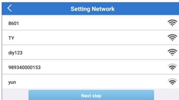
\*Hinweis: Beim ersten Gebrauch erfordert das Tablet eine Dateninteraktion mit dem Server für die Aktivierung, was eine WLAN-Verbindung notwendig macht. Ohne diese Erstaktivierung ist die Diagnosesoftware nicht zugänglich.
