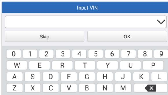
Wenn die VIN erfolgreich dekodiert wurde, führt es eine Smart-Diagnose durch, bis automatisch ein Diagnosebericht erstellt wird. Andernfalls wechselt es in den manuellen Diagnosemodus.
