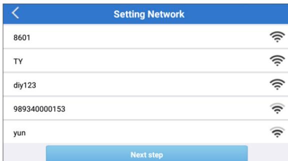
\*Nota: Al momento del primo utilizzo, il tablet richiede l'interazione dei dati con il server per l'attivazione, rendendo necessaria la connessione al Wi-Fi. Il software diagnostico non sarà accessibile senza questa attivazione iniziale.
